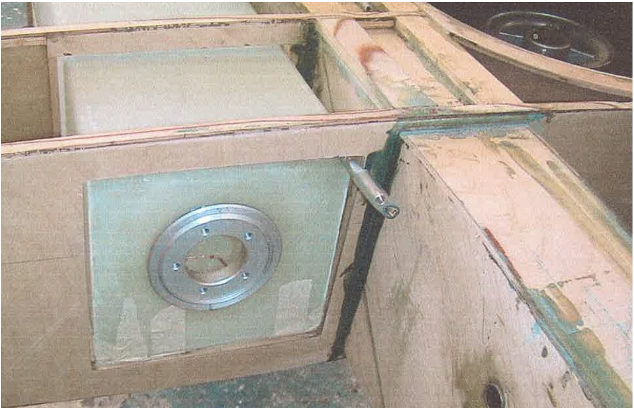
Obr. 3 Křídlová palivová nádrž s přírubou na palivovnak s hliníkovou trubicou pro přívod paliva do motoru
