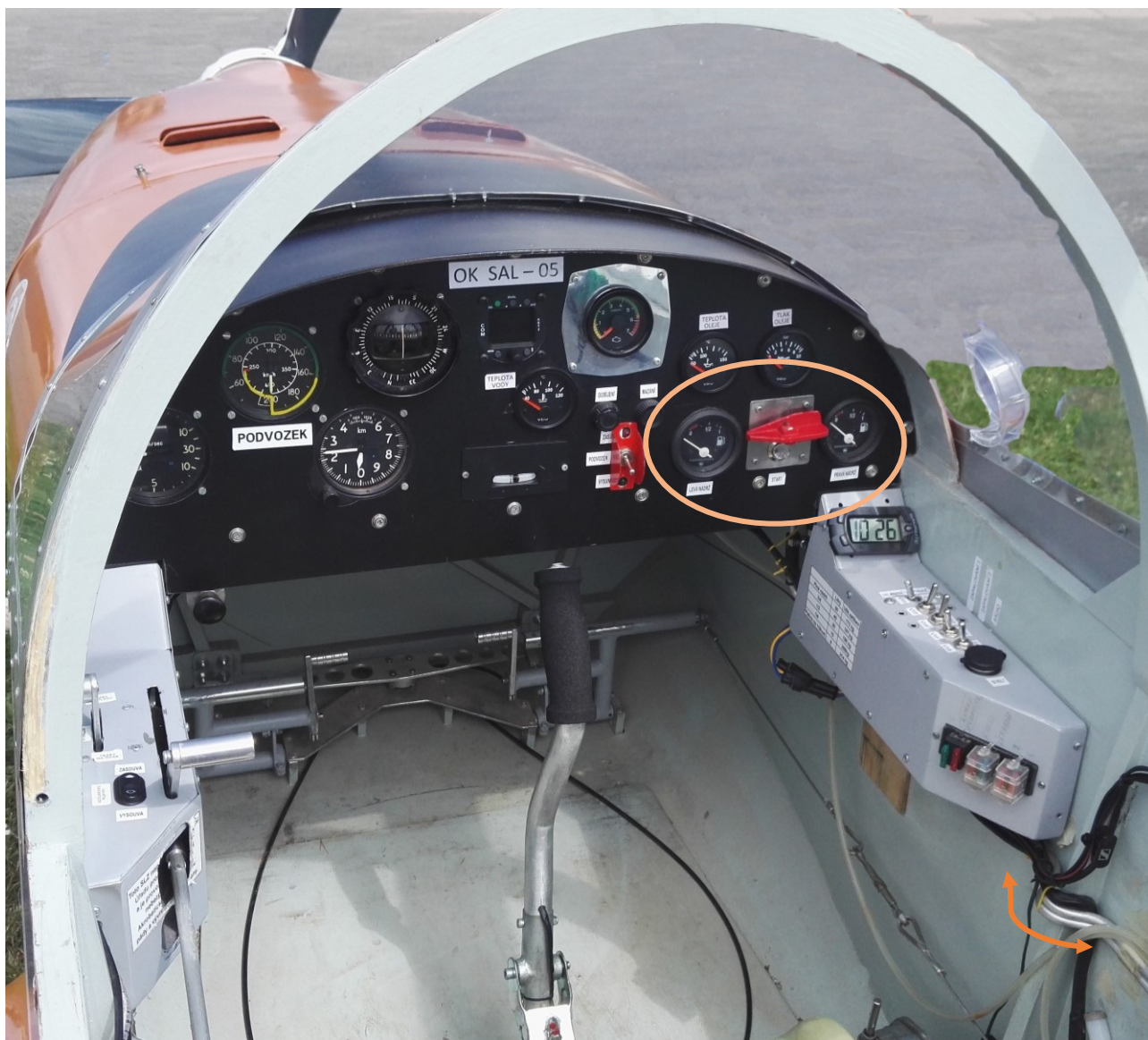
Obr. 2 Ukazatele množství paliva L/P s palivovým přepínačem (červený) L/P a dvě hliníkové trubky pro přívod paliva z křídlových nádrží L/P (vpravo pod přepínací skříňkou)
