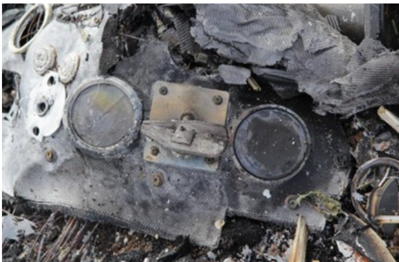
Obr. 6 Palivový přepínač v poloze čerpání paliva z levé křídlové nádrže
