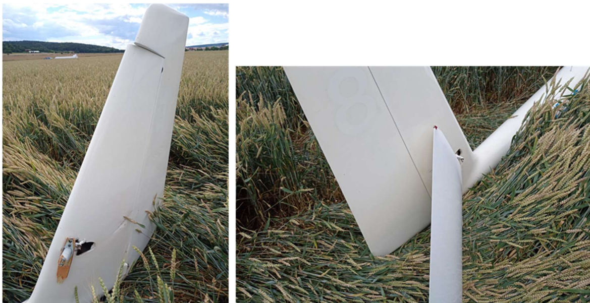
Obr. 2: Poškození ocasních ploch kluzáku
