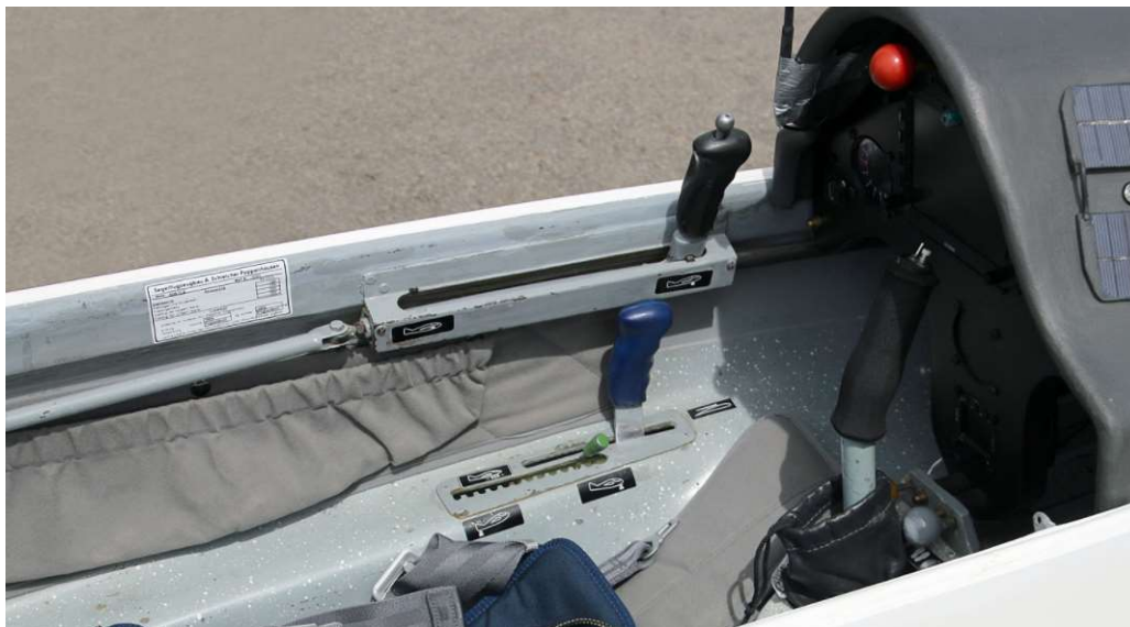
Obr. 3: Černá rukojeť – podvozek vysunut, modrá rukojeť – aerodynamické brzdy zasunuty
