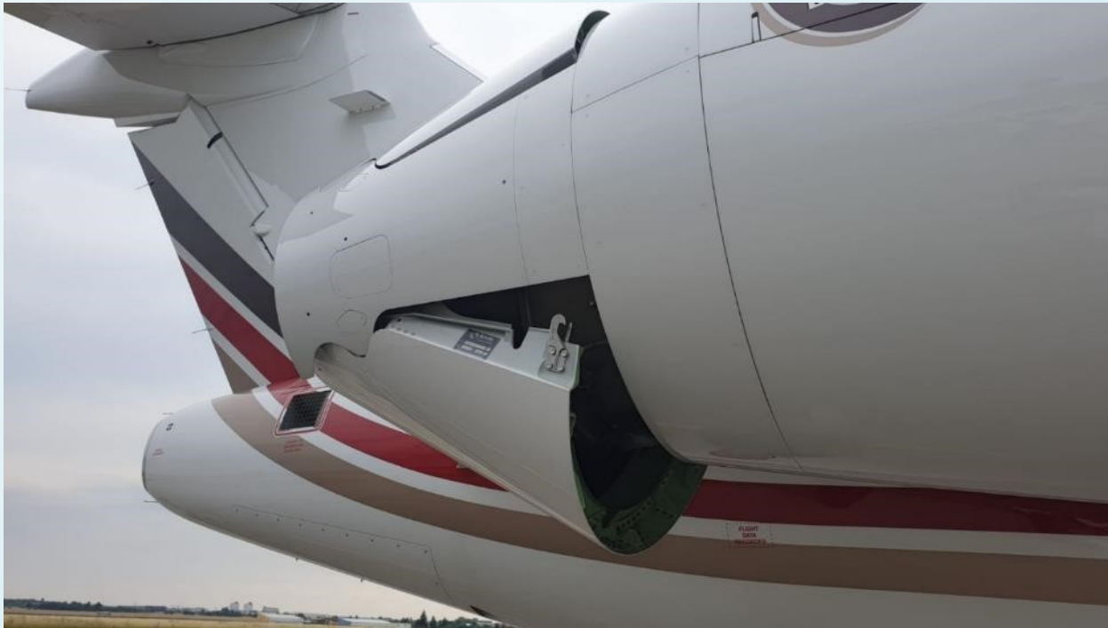
Otevřené klapky obraceče tahu
