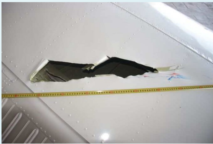
Roztržený potah levé poloviny křídla.
