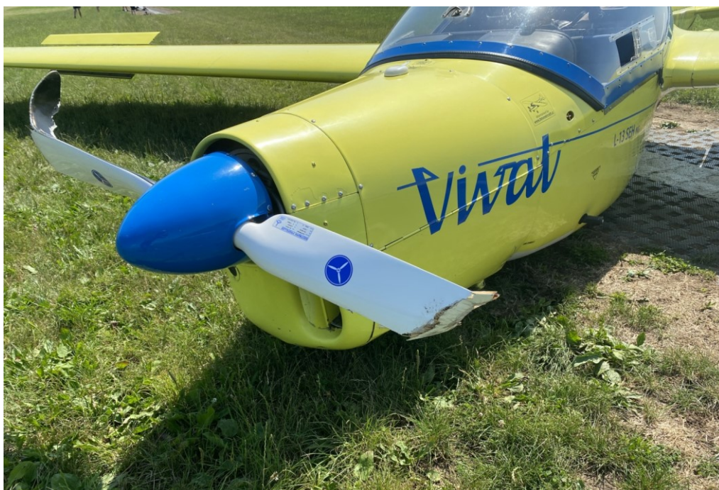
Obr. 3 – Poškozená vrtule a přední část motorového kluzáku.
