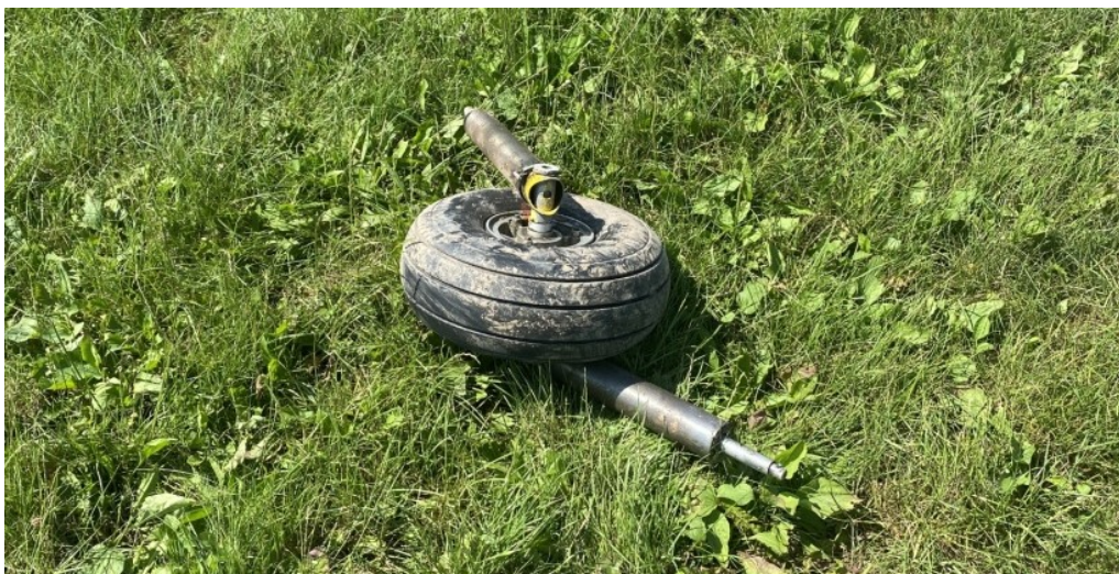
Obr. 2 – Vylomený hlavní podvozek motorového kluzáku.
