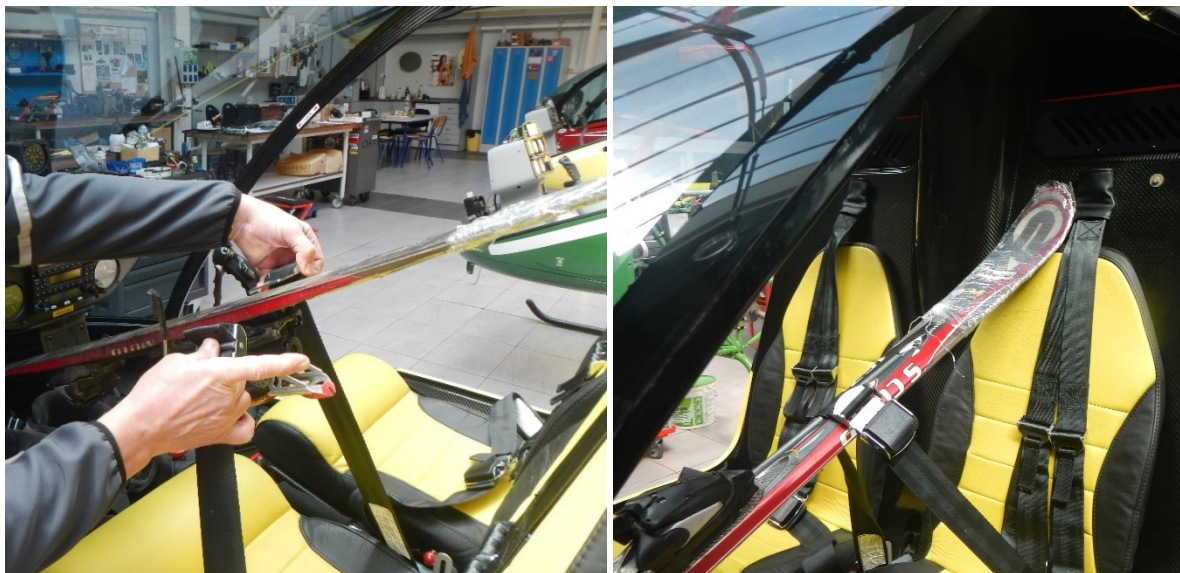
Obr. č. 12 – Uložení a zajištění lyže v kabině UL vrtulníku
