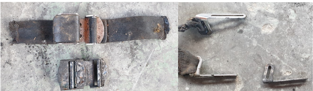
Obr. č. 11 - Uzamčené spony břišních bezpečnostních pásů a volné spony ramenních pásů
