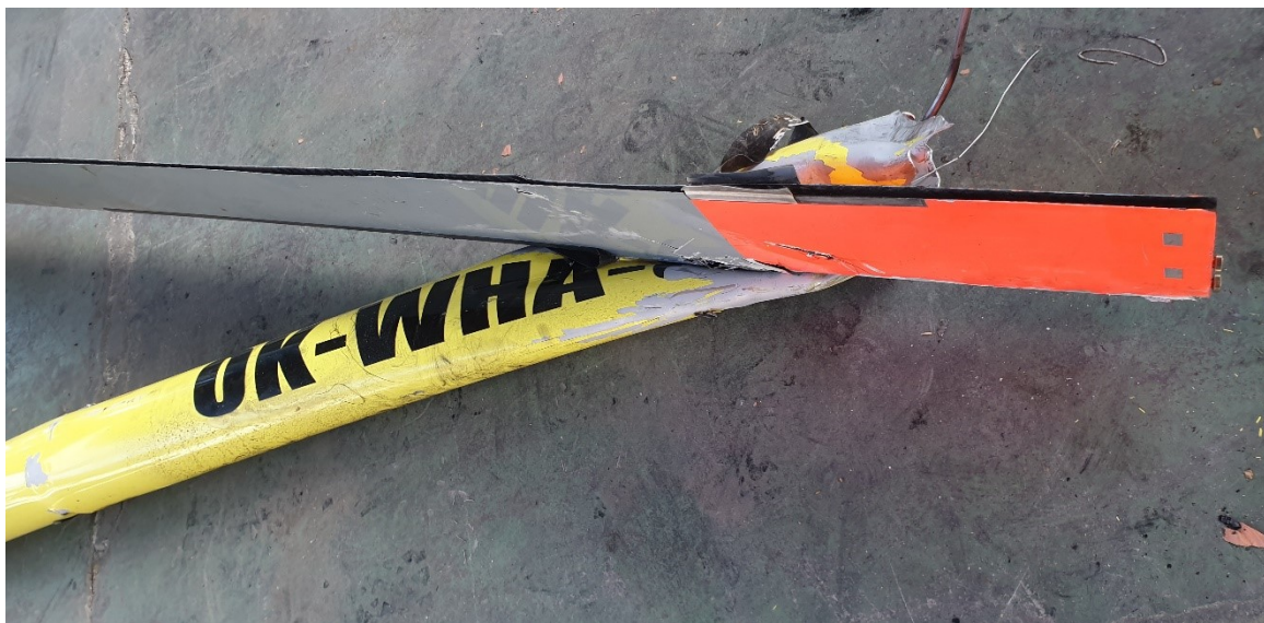
Obr. č. 6 – Místo nárazu listu nosného rotoru S/N 0280 do ocasního nosníku
