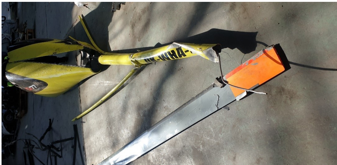
Obr. č. 7 – Poškození ocasního nosníku
