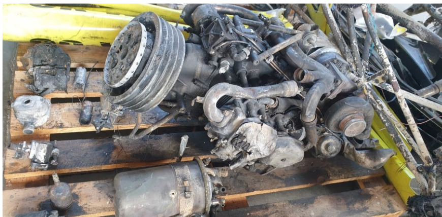
Obr. č. 9 – Trosky motoru EPA Power SA 914-1400 v.č. 4418728
