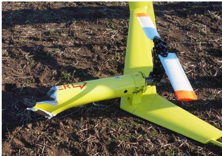
Obr. č. 8 – Zadní oddělená část ocasního nosníku
