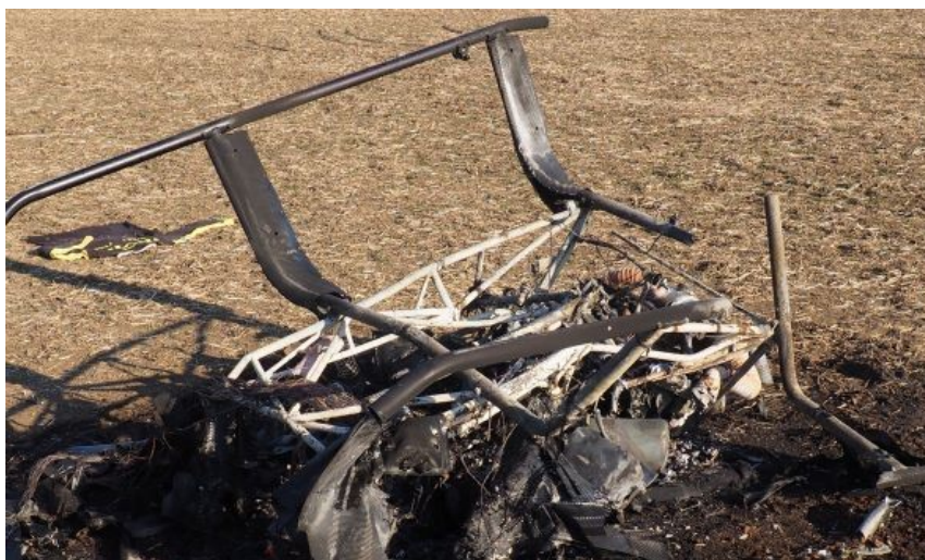
Obr. č. 4 – Ohořelý trup UL vrtulníku na místě letecké nehody
