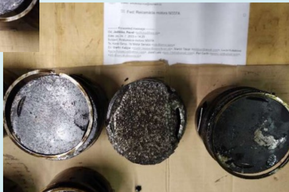
Detail propáleného pístu č. 3
