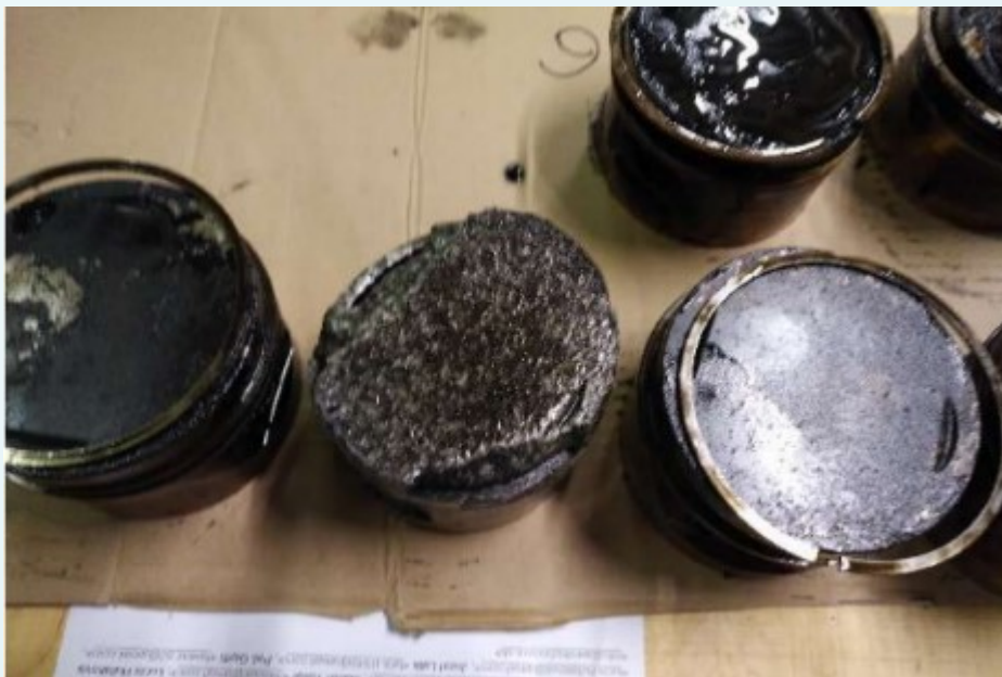
Propálený píst č. 3 a usazení karbonu na ostatních pístech
