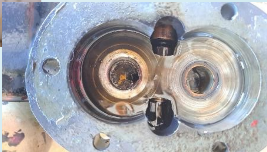
Poškozené olejové čerpadlo motoru letounu Zlín Z-43
