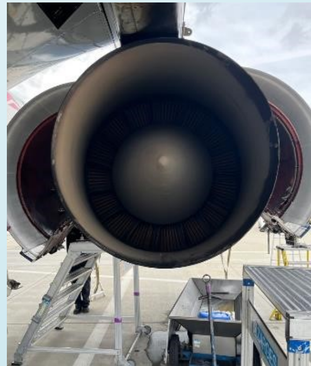
Motor během provádění boroskopické kontroly
