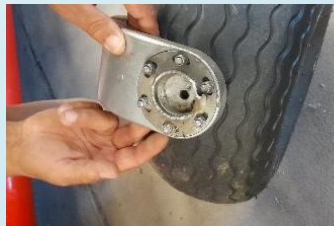
Detail lomové plochy na přírubě levé podvozkové nohy
