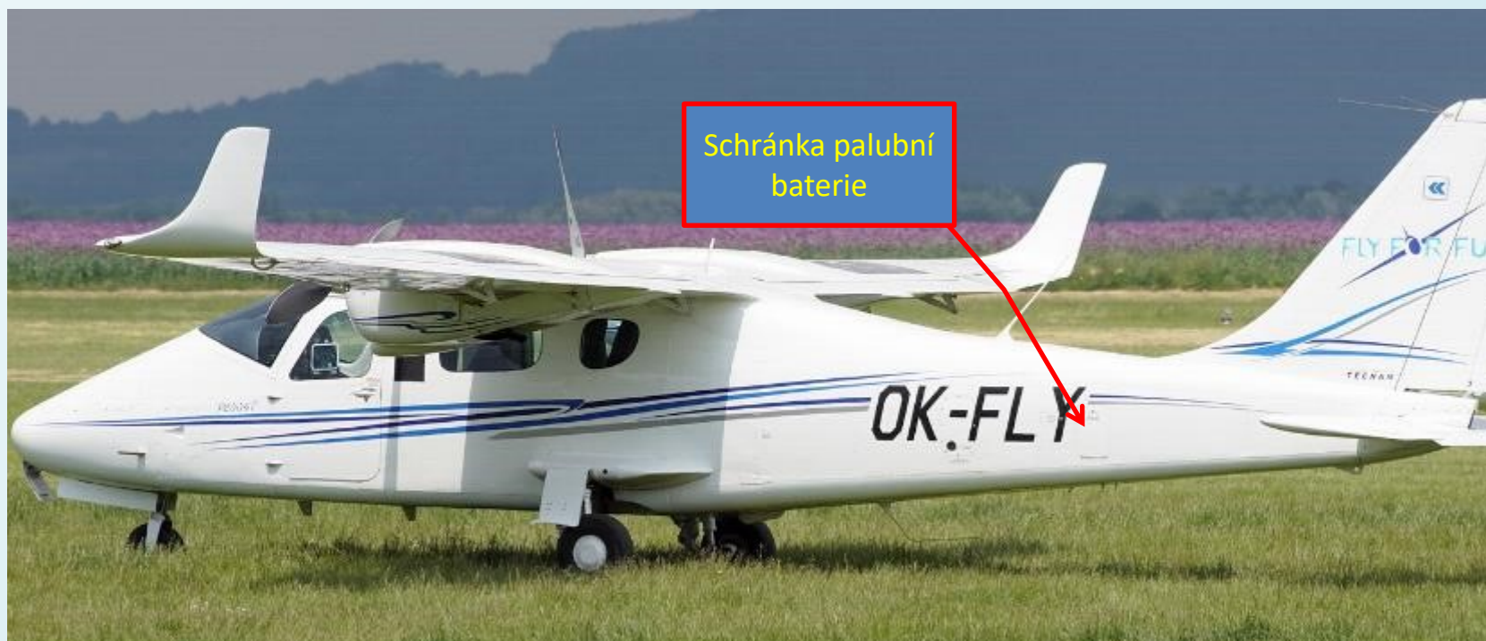
Umístění palubní baterie v letounu Tecnam P2006T
