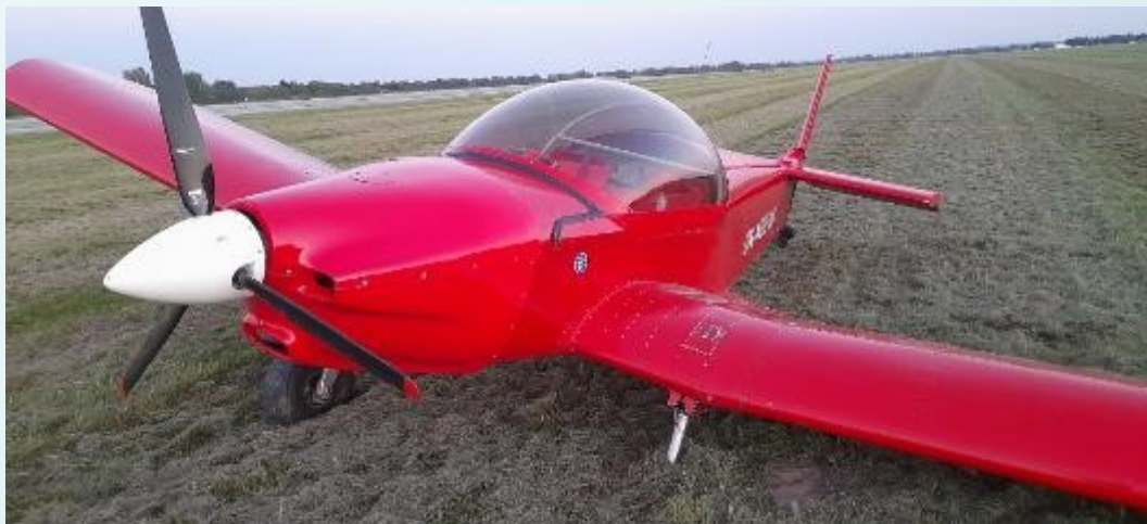
ULL Zenair CH601 s poškozenou levou podvozkovou nohou
