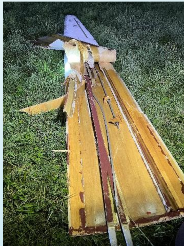
Pravá polovina křídla kluzáku s delaminovaným horním potahem
