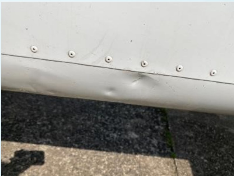
Promáčkliny potahu trupu způsobené baterií
