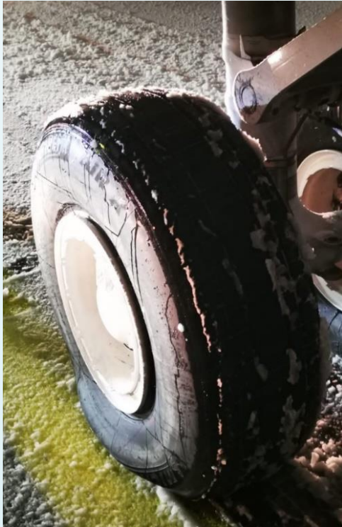
Poškozená levá pneumatika předového podvozku.
