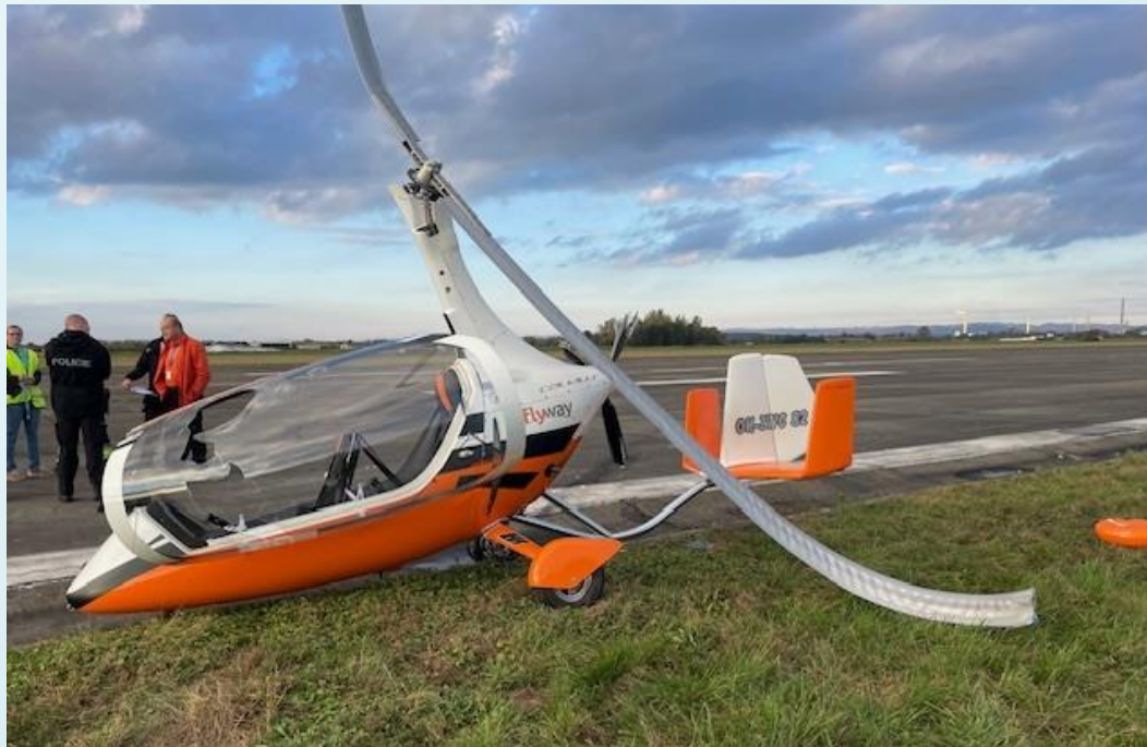
Poškozený UL vírník Calidus
