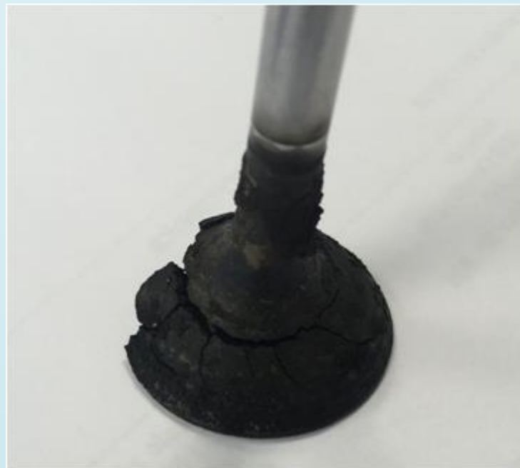
Poškozený výfukový ventil
