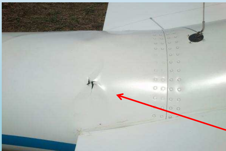
Zborcení a protržení potahu trupu za centroplánem
