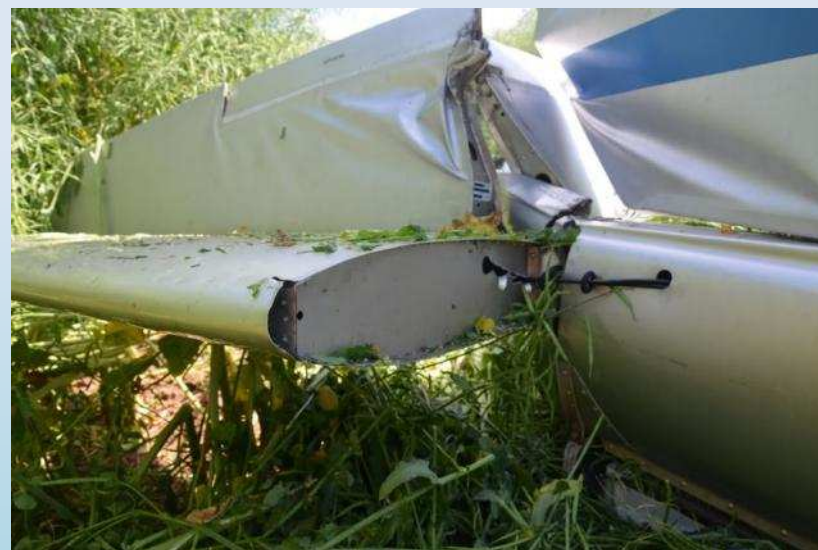
Poškození ocasních ploch kluzáku
