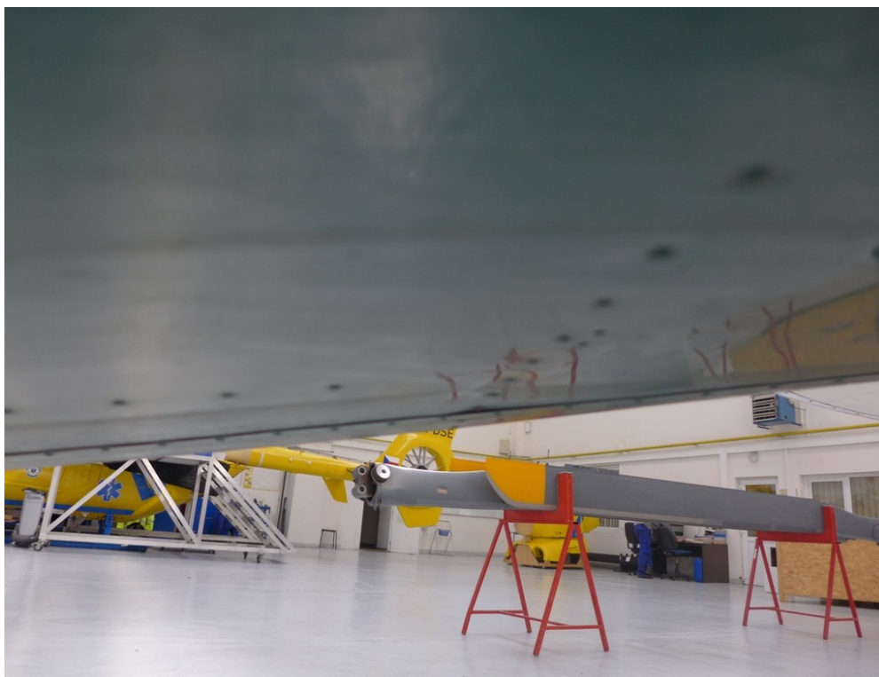
Obrázek č.4 – Poškození LH křídla
