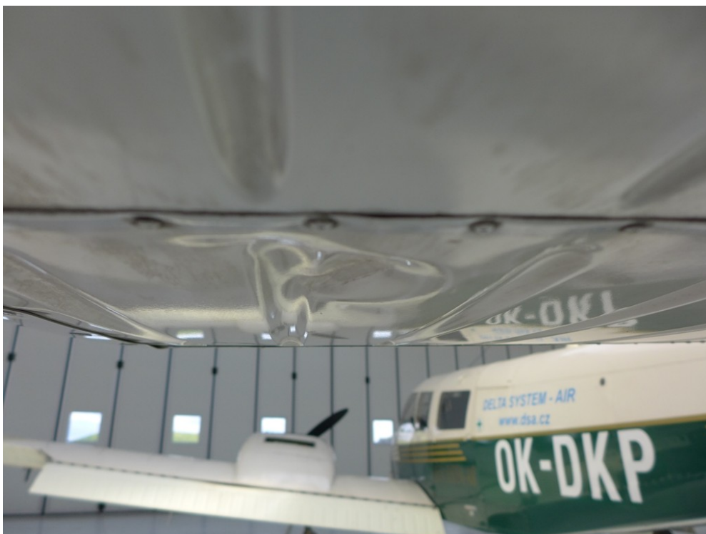
Obrázek č.2 – Zvlněný potah LH výškového kormidla
