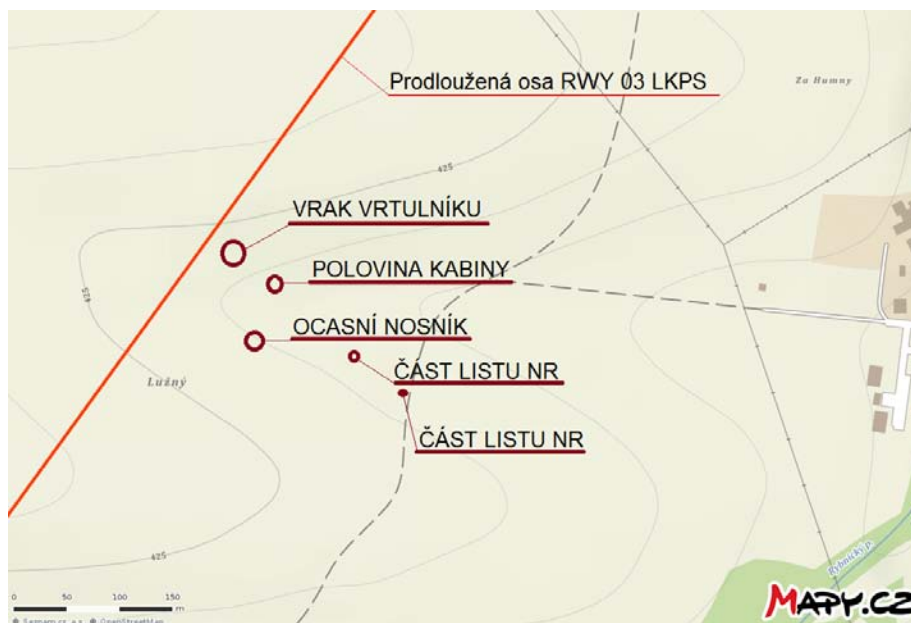
Obr. č. 7: Schéma rozhozu trosek
