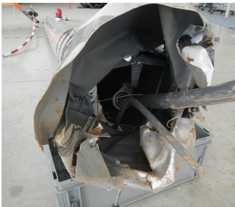
Obr. č. 10: Pohled na část ocasního nosníku oddělenou za letu
