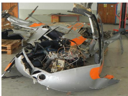
Obr. č. 4: Oddělená část kabiny vrtulníku
