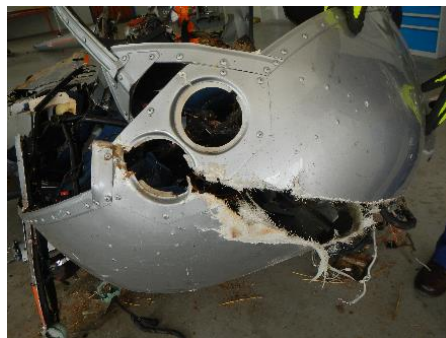
Obr. č. 4: Oddělená část kabiny vrtulníku
