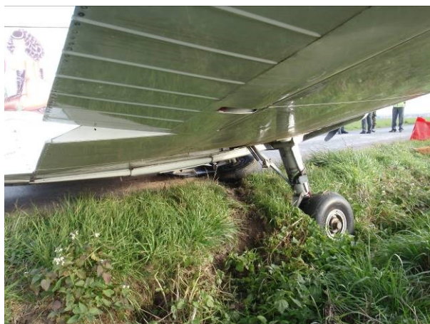
Místo bočního nárazu levého kola
