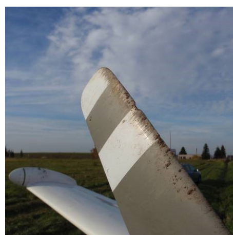
Poškození listu vrtule
