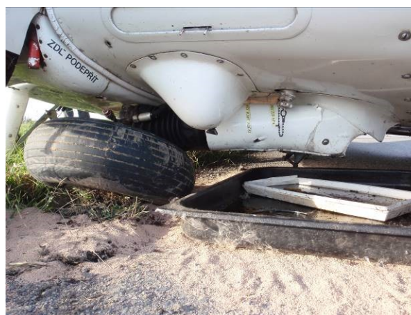
Deformace levé podvozkové nohy
