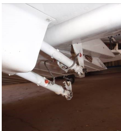
Poškození pák křidélek
