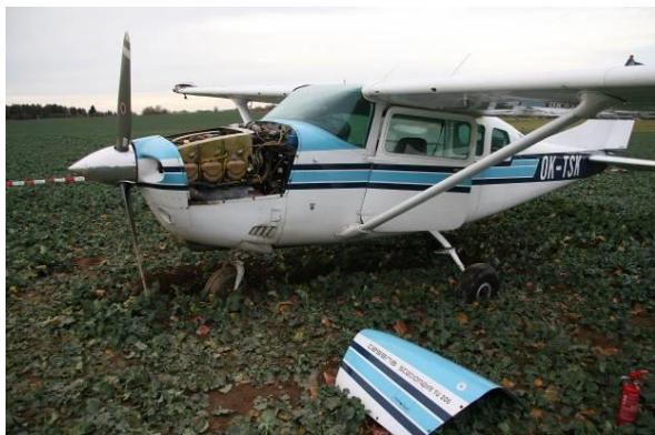
Letadlo po přistání do terénu a poškození konce pravé poloviny křídla
