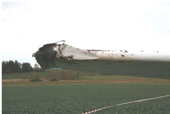
Letadlo po přistání do terénu a poškození konce pravé poloviny křídla
