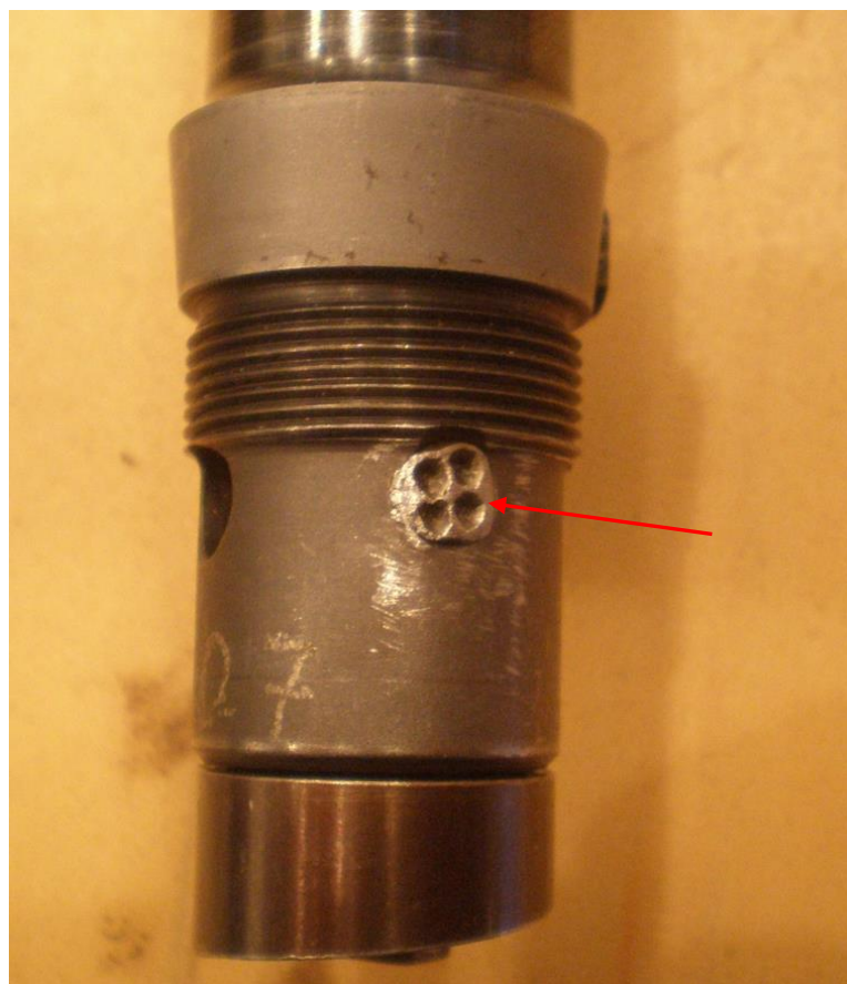
Správné vyhození zajištění kolíku
