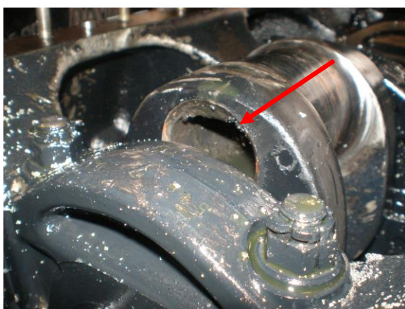
Úroveň karbon-olejových úsad v dutině zdvihového čepu.
