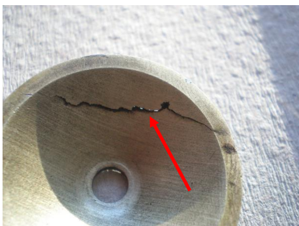
Trhlina v záslepce zdvihového čepu.
