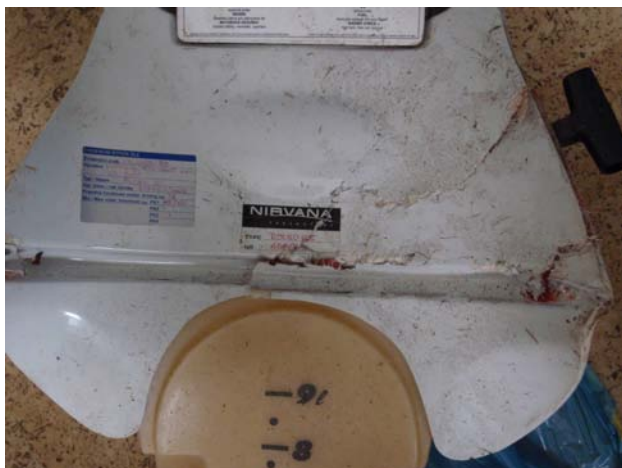
Poškození skeletu vytržením ocelového oblouku výztuhy
