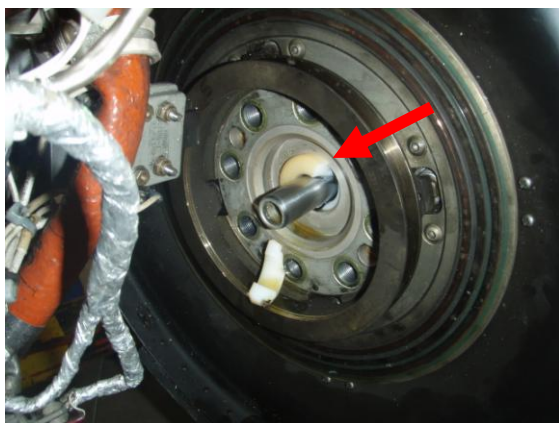
Poškození plastového kroužku (p/n C-3317-211-2)
