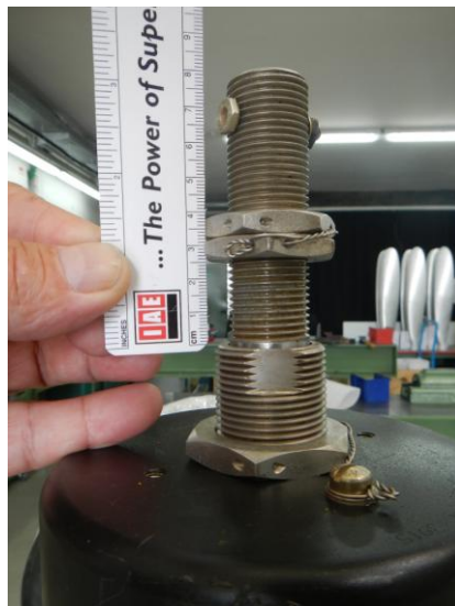
Zafixovaná poloha pístu přestavování vrtulových listů
