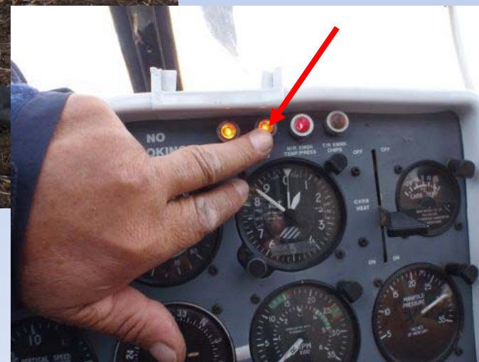
Test žárovky signalizace po nehodě.
